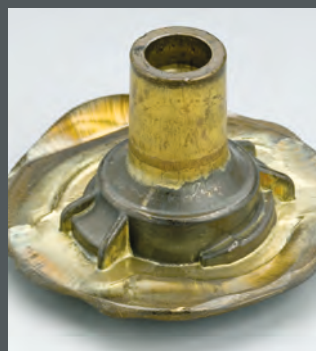
Schmieden des Rohlings bei ca. 700 °C
